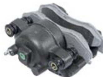
Montage et lubrification d'étriers de freins
